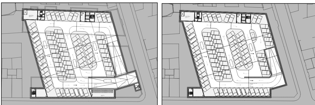
Indeling parkeergarage niveau -1 (met in- en uitgang) en niveau -2 (bron: Wiel Arets Architects)
